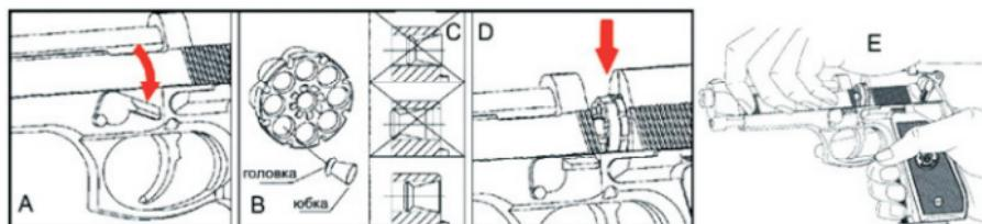
А. Опустите рычаг, фиксирующий затвор пистолета и выдвиньте затвор вперед.
