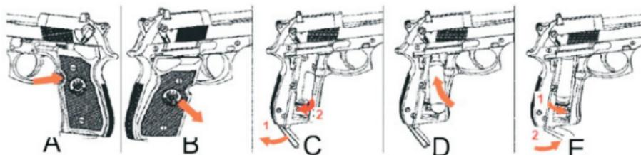
A. Нажмите фиксатор, удерживающий щечку рукояти, закрывающую отсек с баллоном.
