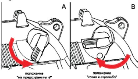
A. Опустите рычаг предохранителя с левой стороны задней части затвора вниз, чтобы поставить Ваш пистолет на предохранитель.
